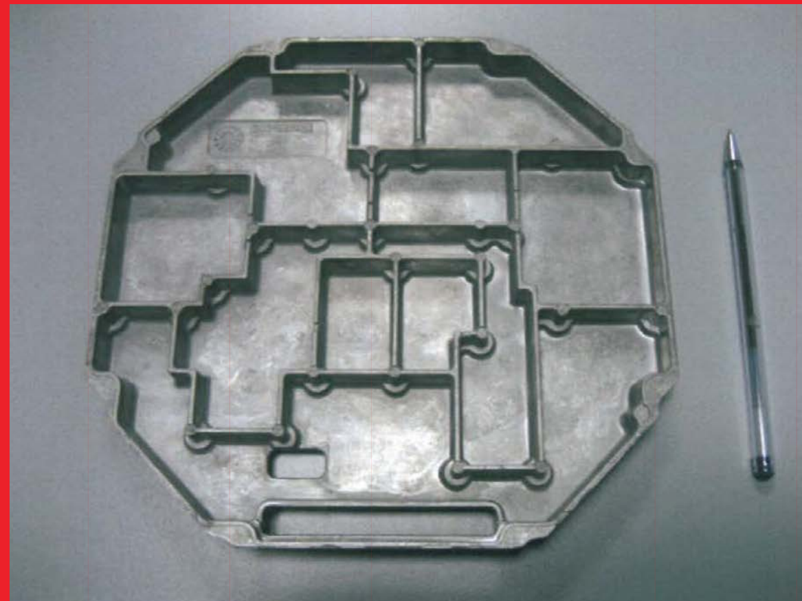
Inyección de componentes de carcasa de cuchilla en una cortadora de césped. Se usaron moldes de Toolox 44.
